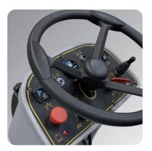
panel de control, el operador puede ajustar la velocidad de trabajo y la cantidad de solución de limpieza, selecciónando la opción más adecuada para cada tipo de suciedad. El trabajo se simplifica y hace más rápido gracias a el sistema automática de levantamiento de la boquilla de secado y de los cepillos
